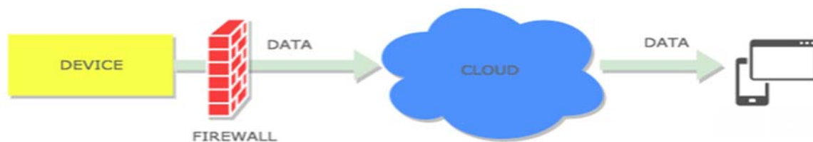
Slika 3: Priključena naprava znotraj IT omrežja enostavno lahko pošilja podatke na oddaljen zunanji strežnik [4].
