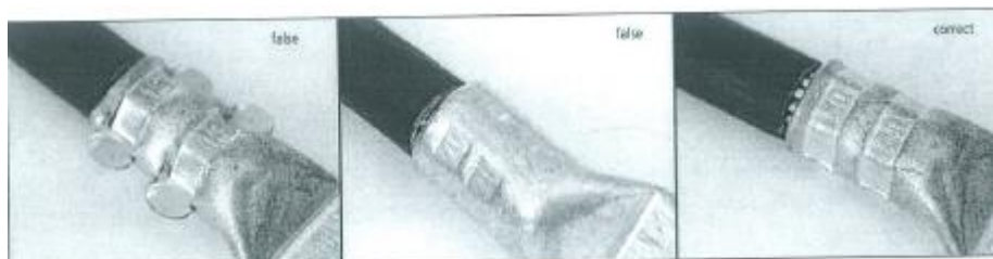
Slika 37: Primeri nepravilnega ter pravilnega stiskanja KČ
