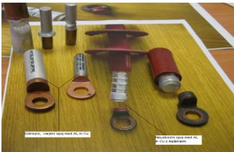
Slika 15: Primeri varjenih (npr. Metal produkt) in neprimernih lepljenih spojev (odlomljen spoj)
