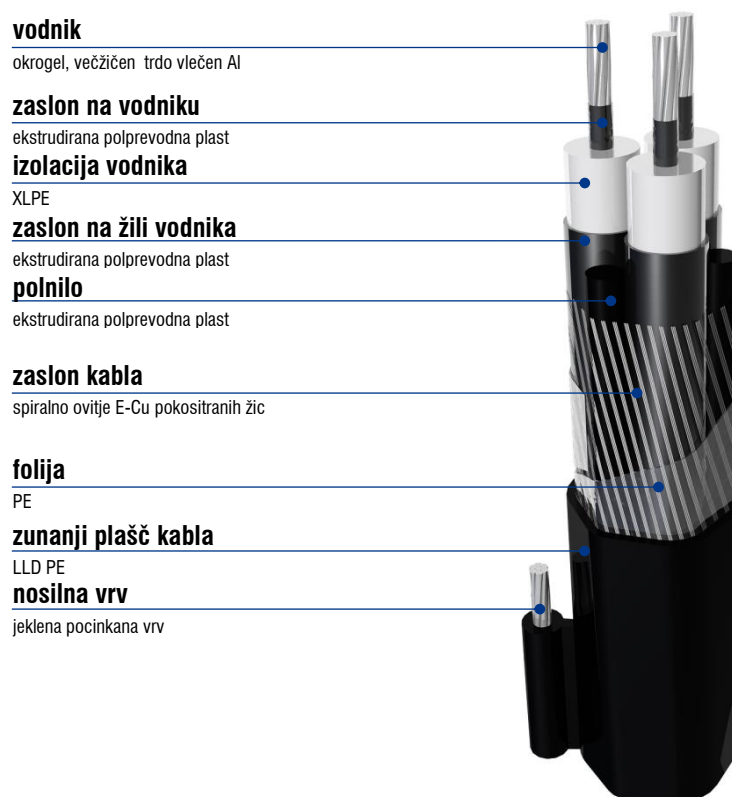
Slika 4: Izgled in sestava univerzalnega kabla z nosilno vrvjo AXCL-H
