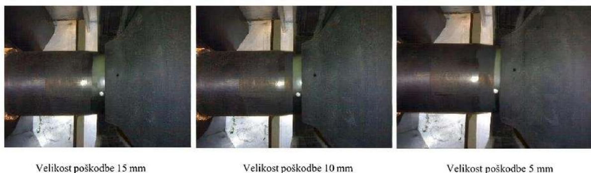
Slika 87: Trije primeri manjkajoče polprevodne plasti pred konusom za oblikovanje potenciala
