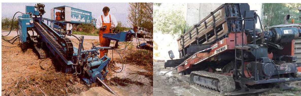
Slika 18: Manjša in večja naprava za podvrtavanje
