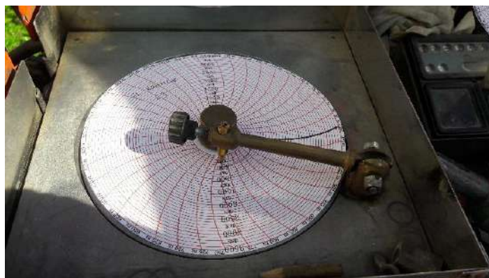
Slika 22: Dinamometer za registracijo vlečne sile pri polaganju kablov
