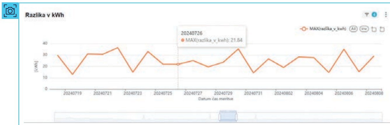
SLIKA 15: RAZLIKA V KWH MED ODJEMALCI TER ŠTEVCEM V TRANSFORMATORSKI POSTAJI
