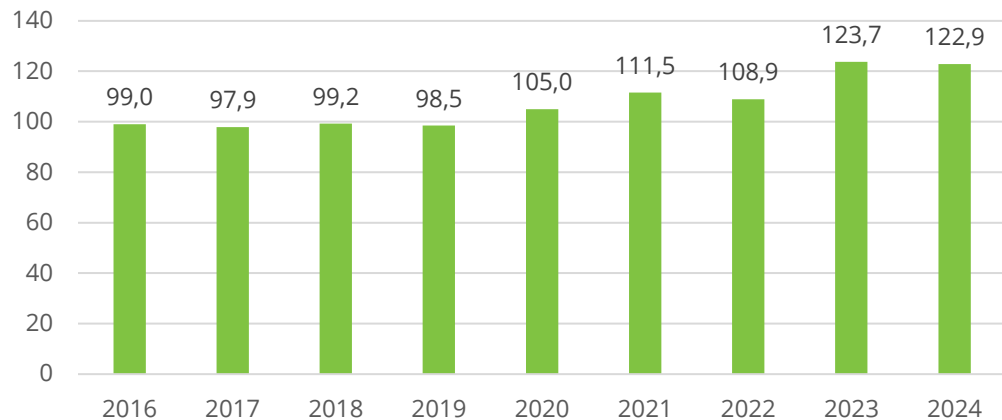
Povprečna napetost transformatorjev na VN strani [kV]
